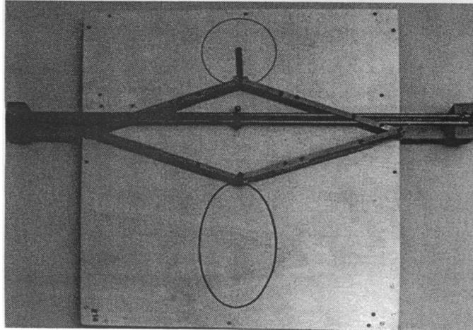
下の図で、四角形PXZYはひし形であり、ひし形の辺に固定された点Aと点Bは辺XYに平行な直線*m*の上を滑り動くことができ、点Pは点Oを中心とする円の上を動きます。描画点Zが点Pの真下に位置するのは明らかです。また、三角形PABと三角形PXYが相似であり、三角形ZYXと三角形PXYが合同であることから、 $PA : AX = 1 : t$  とすると、点Pの直線*m*からの距離と、点Zの直線*m*からの距離の比が、 $1 : 2t + 1$ となります。つまり、点Zの軌跡は円Oを縦方向にのみ $2t + 1$ 倍に拡大した図形であり、楕円であることがわかります。
